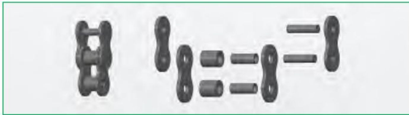
Schema di accoppiamento tra maglia interna e maglia esterna
