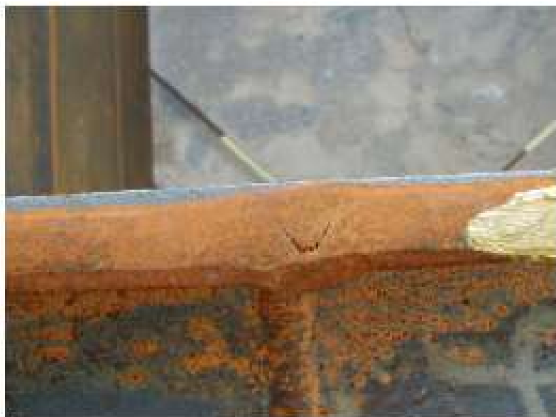
Manca di penetrazione, incollatura
