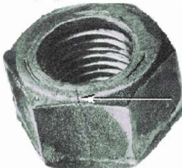
Ripiegatura: aspetto tipico e micrografico
