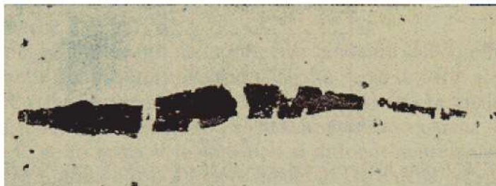
Aspetto micrografico di inclusioni frantumate nella laminazione
